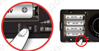
Установка режима автоматической блокировки
